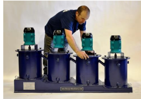
TANQUES DE LIXIVIACION PILOTO
