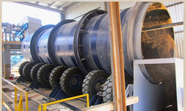
Parte inferior derecha: Aglomerador sobre ruedas de 2.4m (8ft) en una operación de patios de lixiviación de oro en México
