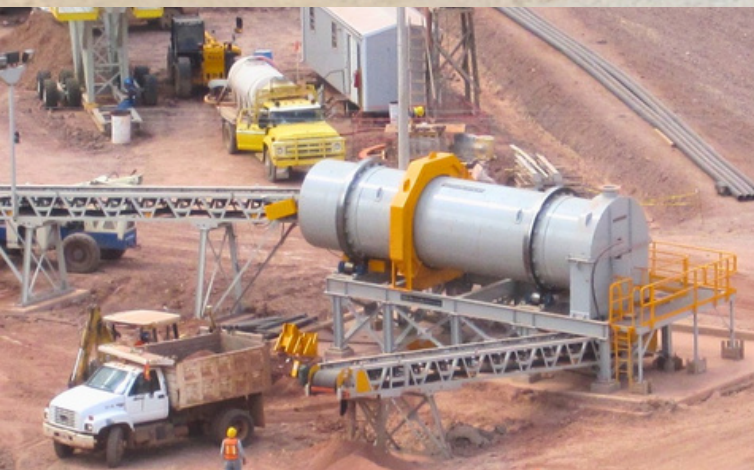
Parte inferior derecha: Aglomerador sobre ruedas de 2.4m (8ft) en una operación de patios de lixiviación de oro en México
