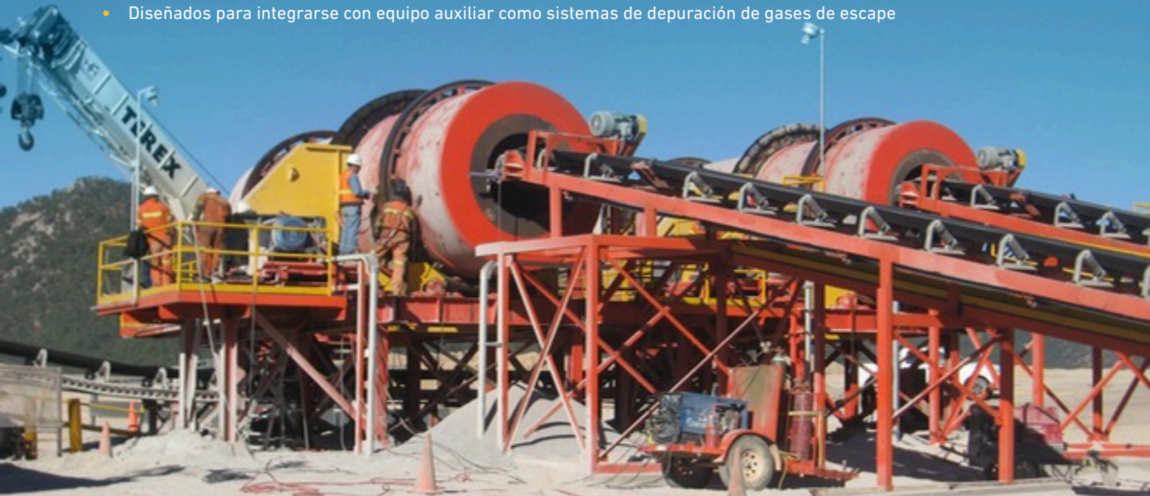
Parte superior: Dos aglomeradores de cadena de 3m (10ft) de diámetro en una operación de patios de oro en México
